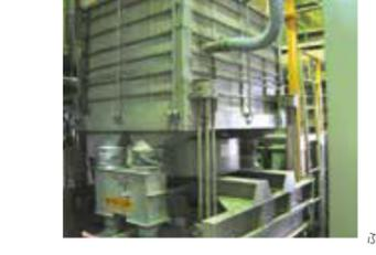
網目の違う多段に積み重ねた篩を水平に振動させ、大きさの違ったものをふるい分けします。
