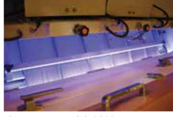
光センサー・近赤外線センサーにより、色・形・光の反射が違うものを感知し、エアで吹き飛ばして除去します。
