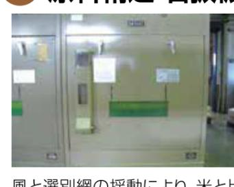
風と選別網の揺動により、米と比重・形状が違うものを選別します。また、強力マグネットによって金属類も吸着されます。
