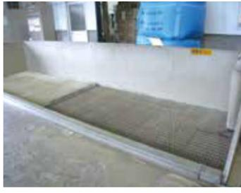
玄米を大きな投入口から投入(張込み)します。
