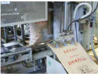
規格にあった量の米を充填し、自動で袋の口を閉じます。
